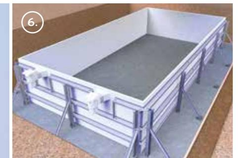
6. Installer les éléments enterrés (skimmer, refoulement)
