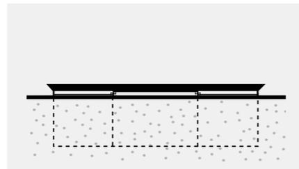
Les piscines Octoo et Oblong doivent être installées sur une dalle de béton ou sur un sol stabilisé. Les piscines Quartoo et Rectoo doivent être installées sur une dalle de béton armé.
